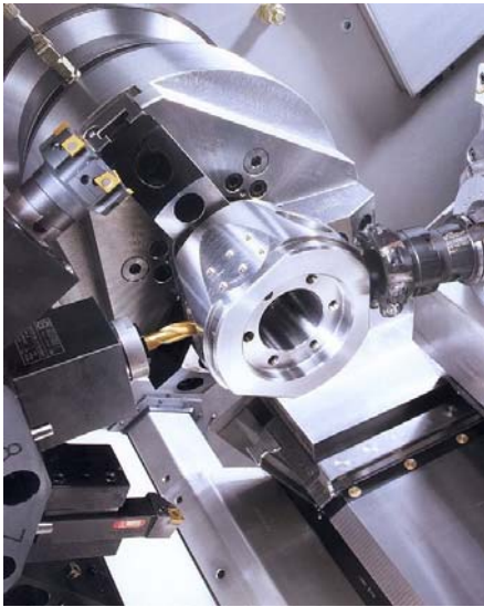
Bild 1. Många axlar och frihetsgrader i maskinen, samt effektivt verktygsutnyttjande, innebär att omställningen mellan olika partier till största del kan ske mjukvarumässigt. /DMG/
